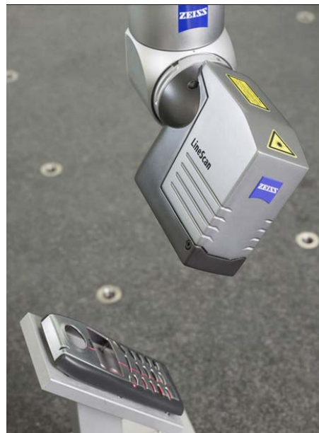
Slika 16. Beskontaktni merni senzori kompatibilni sa mernom glavom RDS
